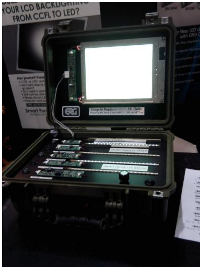
Рис.14. Дисплеи Endicott Research Group со светодиодной подсветкой, демонстрирующие ее преимущества перед люминесцентными лампами с холодным катодом.
